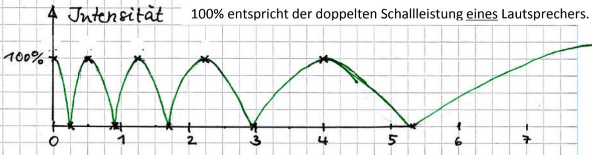
Auf dem Weg von M nach  $L_1$  beobachtet man 4 Intensitätsmaxima:  $k=6$  und damit  $x=0\text{m}$  und  $M=L_1$  wird nicht mitgezählt: Das Mikrophon müsste dafür an der Stelle des Lautsprechers sein. Vergleichen Sie die Intensitätskurve auch mit dem Bild den vorherigen Interferenz-Muster.
